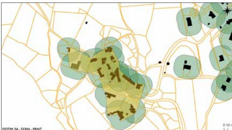
Des « tampons » de 25 m (en vert) sont apposés autour des constructions principales existantes. Lorsque 2 tampons se touchent, cela signifie que les constructions sont inter-distantes de 50 m au maximum.
