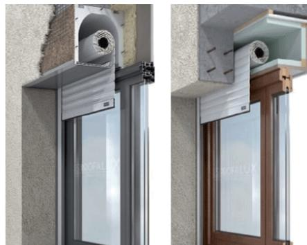
Exemples de dispositifs intégrés d'enroulement des volets autorisés
